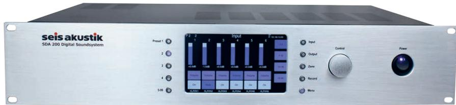
leichteste Bedienung. Dabei ist die umfangreiche Hardware mit 24 Signaleingängen, 12 Signalausgängen, Dante-Netzwerkstruktur, edlem Farb-Touch-Panel und integrierten digitalen Leistungs-Endstufen für Ihre Anwendung extrem zukunftssicher.
